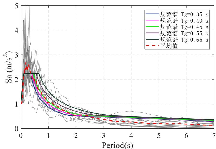
图 A.1 四川地区波库多遇地震加速度时程记录反应谱信息
