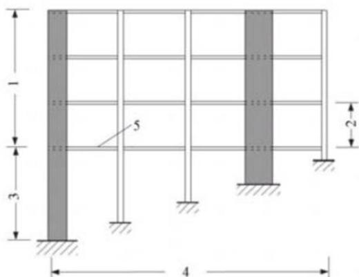
图 2.1.5-1 吊脚结构
