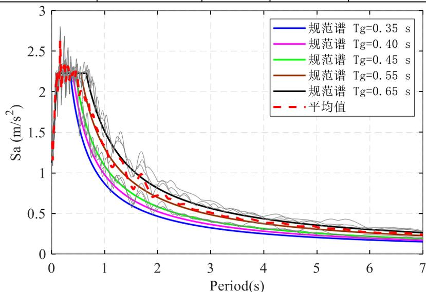
图 A.2 四川地区波库罕遇地震加速度时程记录反应谱信息
