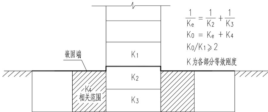
图 2 嵌固等效刚度计算示意
