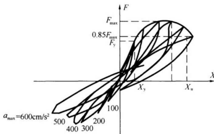
图 7.4.3 基底总剪力-顶端水平位移包络线
